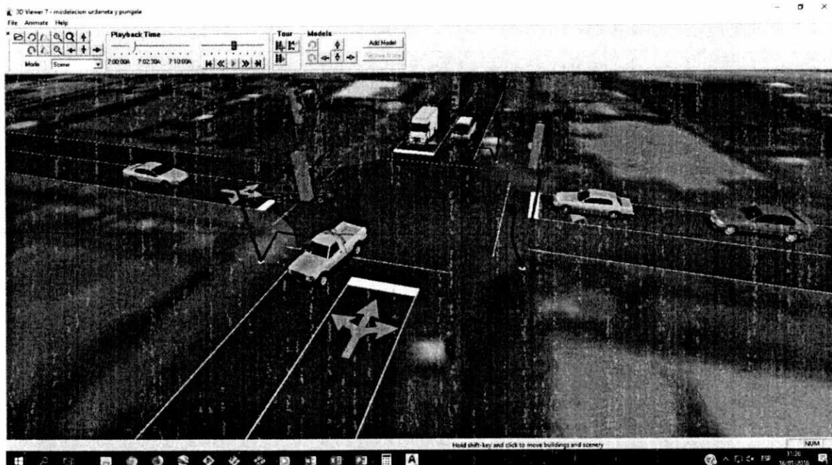
Gráfico 4.- Modelación de 3D de los volúmenes vehiculares de la intersección de las calles Pungalá y Urdaneta, análisis con señalización existente.
