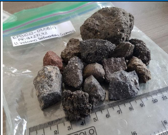
Foto 2.- 09/08/17 PK 13+271,42 - Unidad Volcano Sedimentaria Guamaní, clastos de roca volcánica de composición andesítica y escoria, tamaños >3cm de coloración variable
