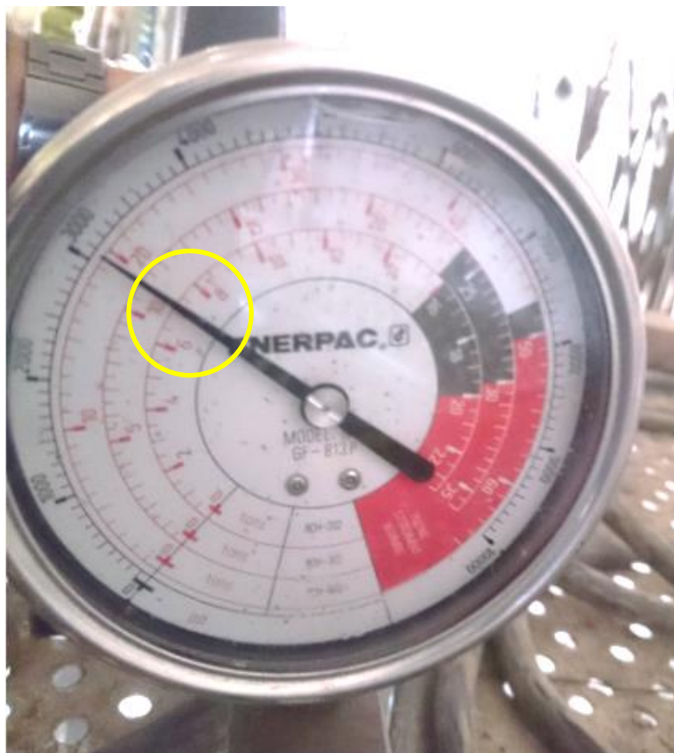
Foto 4. Aplicación de carga en el anclaje 02.
