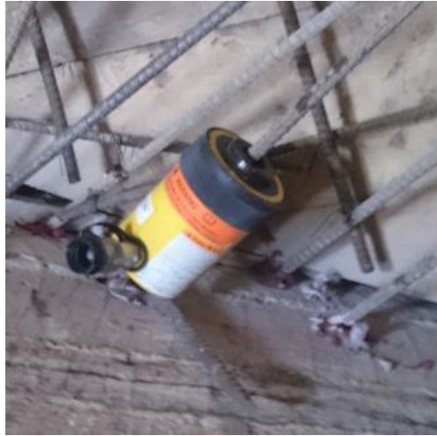
Foto 1. Vista del cilindro previo a la aplicación de carga en el anclaje 01.
