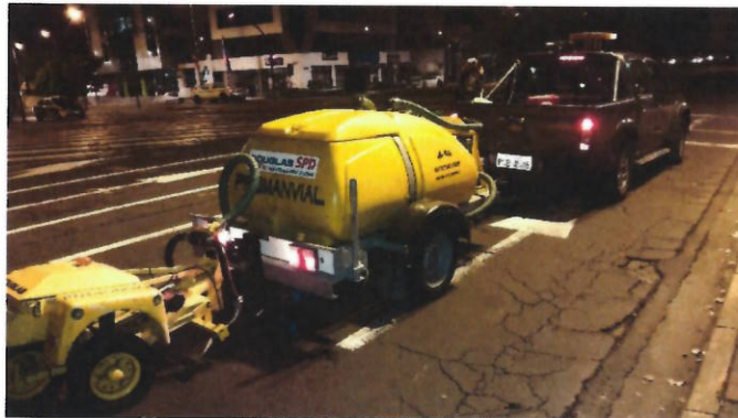
Medición resistencia al deslizamiento (Mu-meter)
