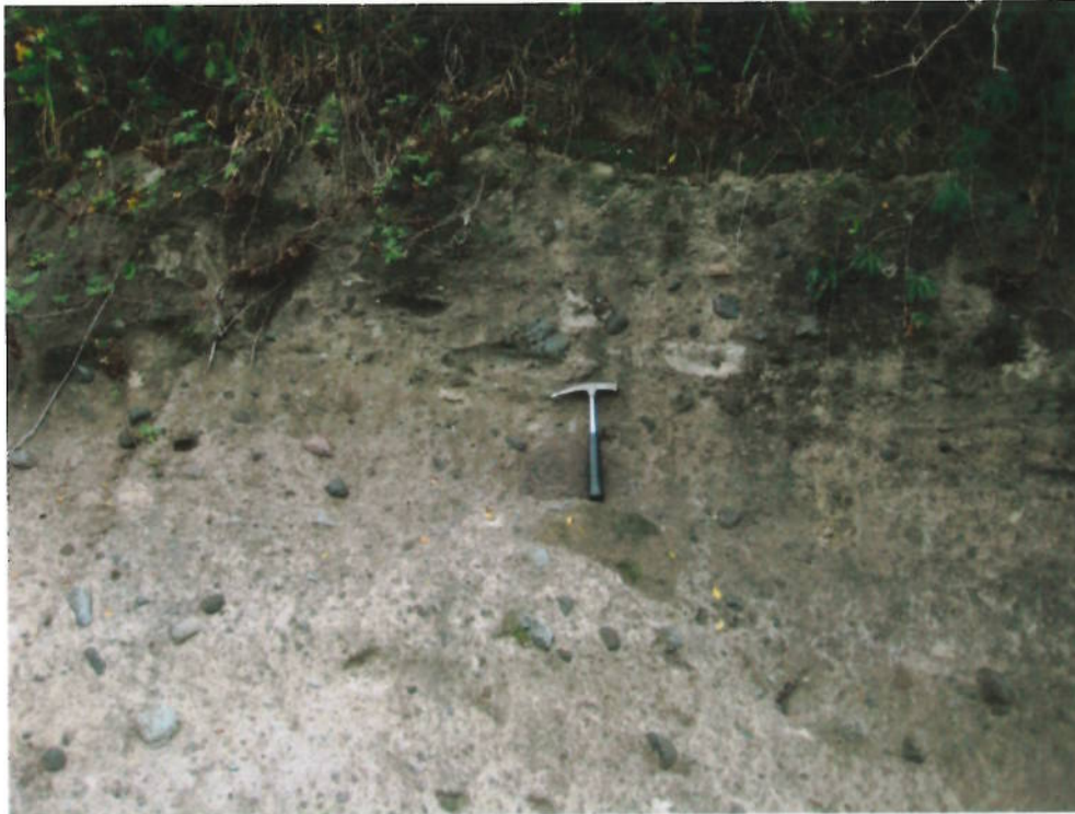
Depósito de lahar “enchapado” sobre tobas de la Formación Cangahua. Bloques rocosos, cantos y gravas inmersas en limos arenosos; compactos. Lugar: margen derecha de río San Pedro, en zona de puente proyectado.
