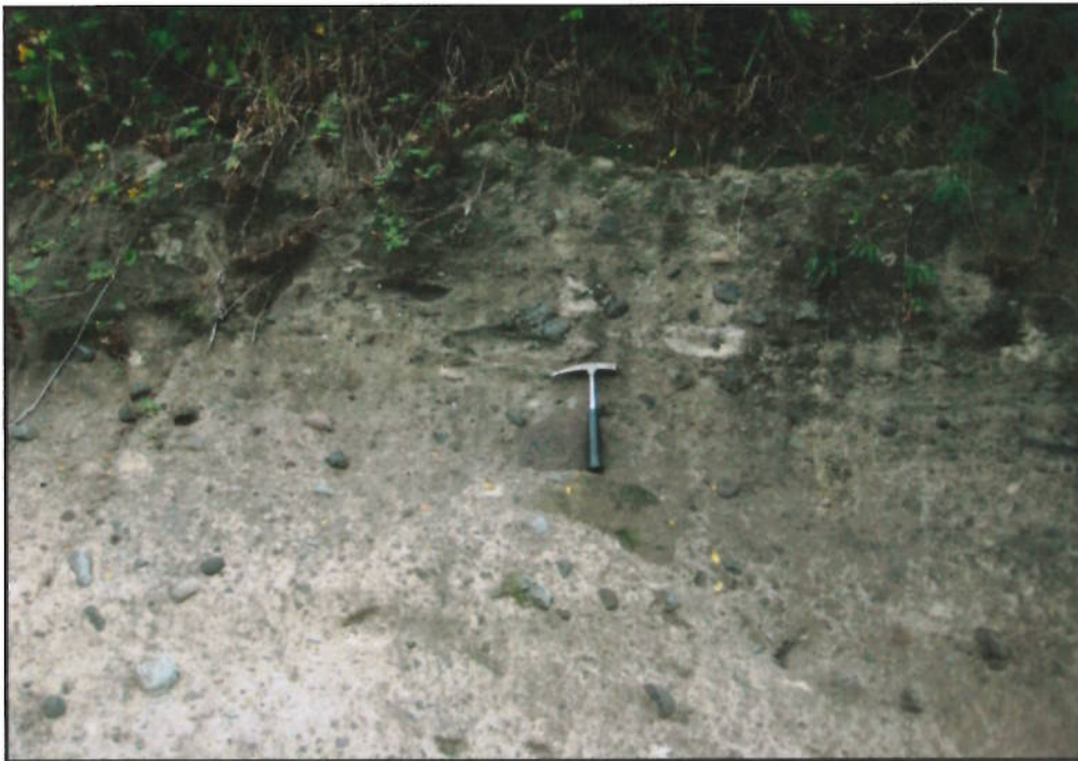
Depósito de lahar “enchapado” sobre tobas de la Formación Cangahua. Bloques rocosos, cantos y gravas inmersas en limos arenosos; compactos. Lugar: margen derecha de río San Pedro, en zona de puente proyectado.
