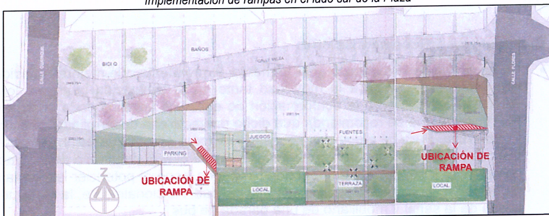
Figura No.15 Implementación de rampas en el lado sur de la Plaza
