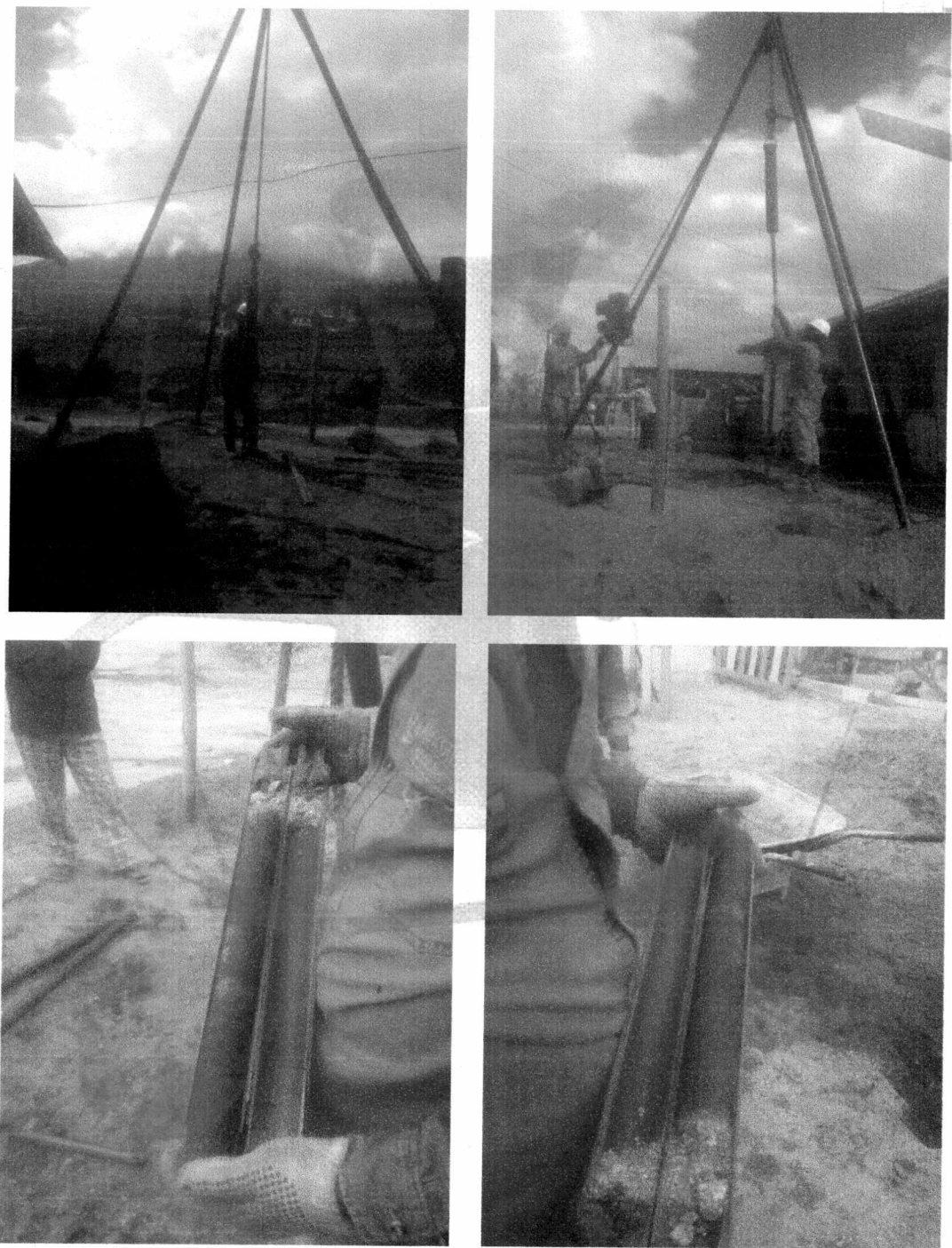
PERFORACION SPT IN SITU Y RECUPERACION DE MUESTRAS
