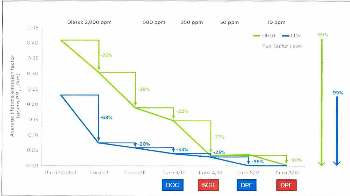
Gráfico No. 22 Factores de emisión de partículas para buses de diésel Fuente: https://www.theicct.org/sites/default/files/Blumberg_SEDEMA%20taller_2016.pdf
