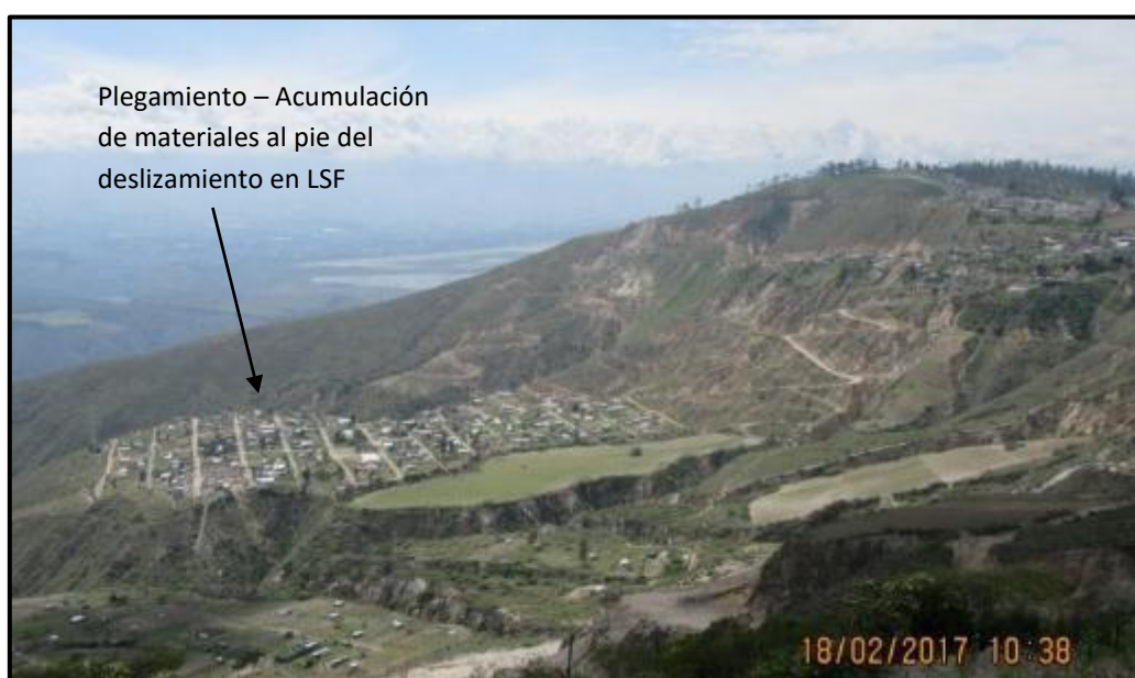
Foto Nº 8.2. Deslizamiento Rotacional de Laderas de San Francisco (LSF), se observa como hay una acumulación de material al pie del deslizamiento en Planada de San Francisco
