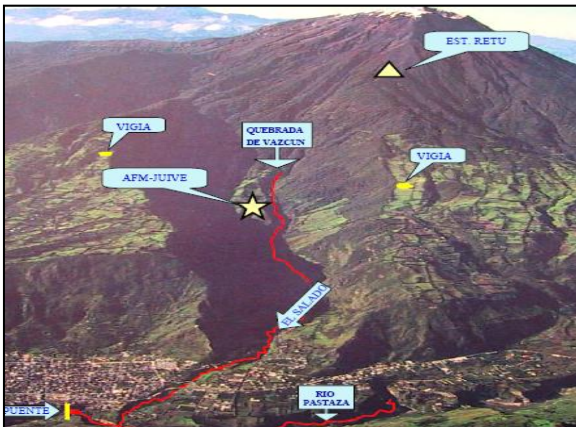
Figura N° 14.2. Esquema del SAT para flujos de lodos (lahares) en Baños (IG-EPN, web page). Ilustración
