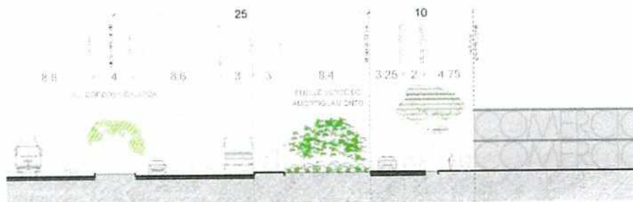
Imagen 8. Corte de la autopista Córdoba Galarza y área contigua.
