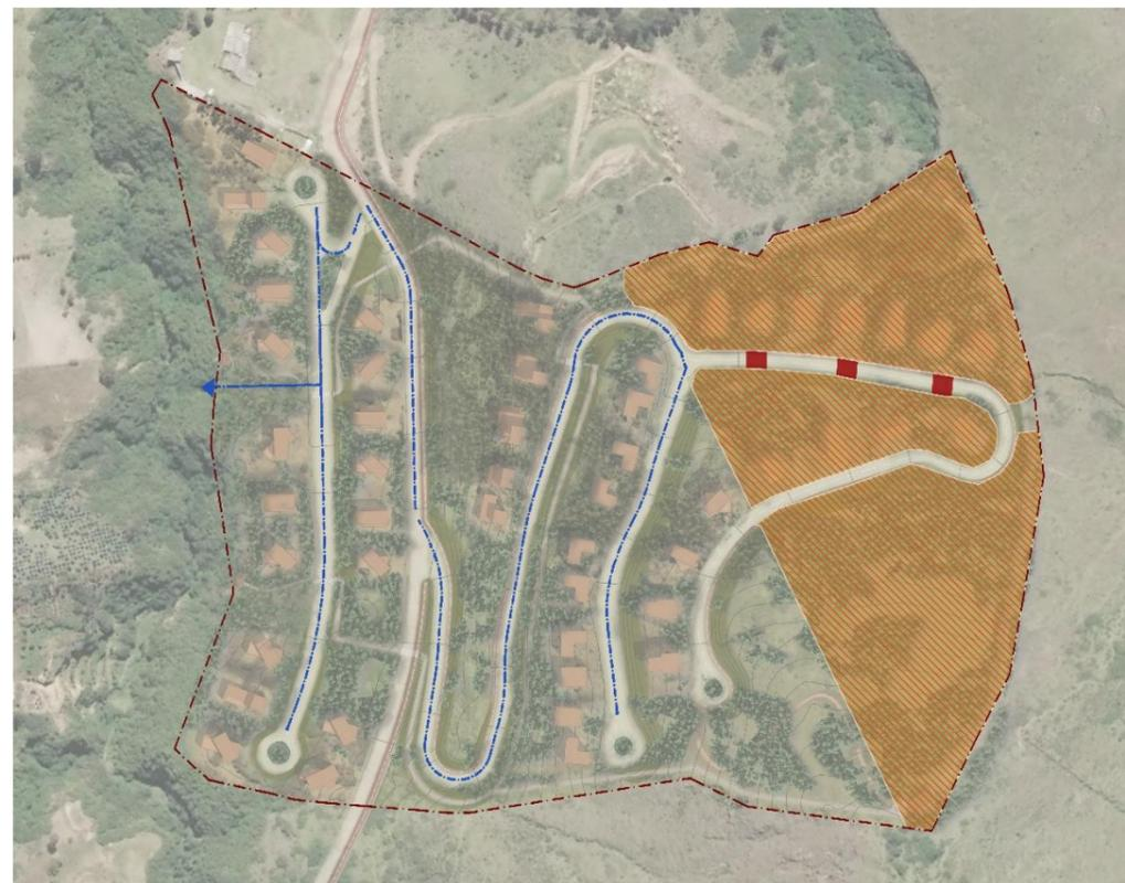
Fig 92: Cuenca hidrográfica de quebrada Hilario (en naranja) con pasos drenantes bajo la vía (en rojo).
