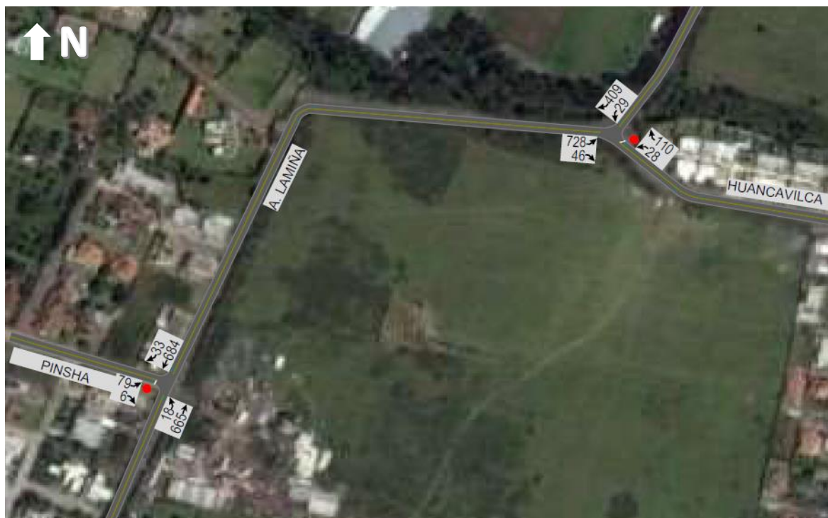
Ilustración 3-14: Volumen de vehículos (VLE) “sin proyecto”. Hora Pico 07H00 Fuente y Elaboración: A&V Consultores
