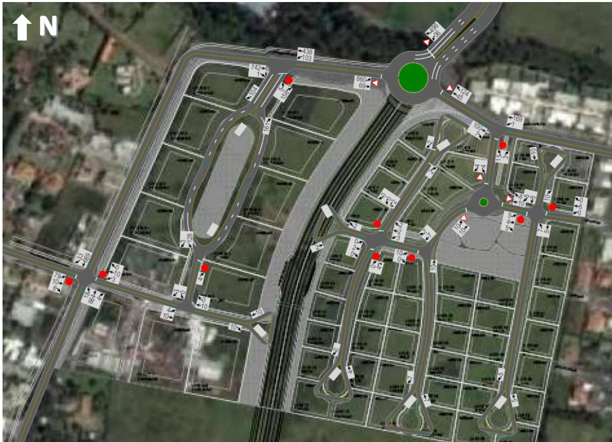
Ilustración 4-9: Volumen de vehículos (VLE) “con proyecto” porcentajes observados de ingreso y salida de vehículos con redondel intersección Alfonso Lamiña y Huancavilca. Hora Pico 07H00
