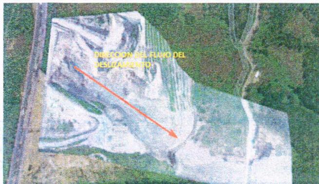
Fotografía 1. DESLIZAMIENTO EN LA PARTE SUR DE LA ESCOMBRERA
