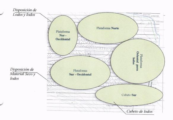
La disposición de material seco se recepta en la plataforma sur con el fin de conformar las bermas y un dique de sustento para lodos que escurren hacia el cubeto ubicado en la zona Sur-Occidental.
