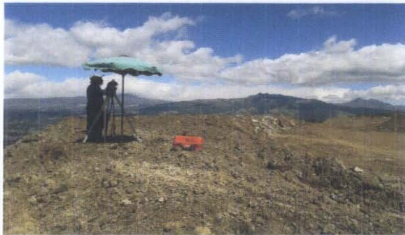
LEVANTAMIENTO TOPOGRÁFICO DE ESTADO ACTUAL DE ESCOMBRERA
