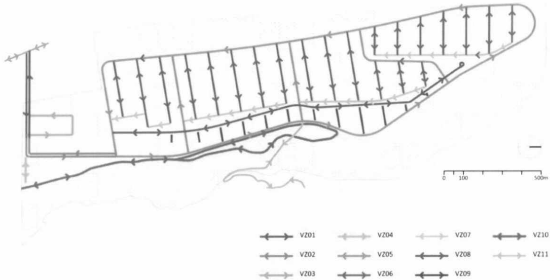
Ilustración 8: Tipología de Vías Internas
