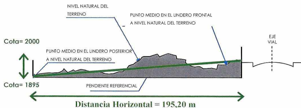
Anexo 40 Ejemplo del cálculo de pendiente descendente con respecto al nivel de la vía
