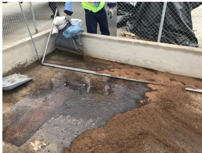
Distribución del polvo absorbente sobre el combustible
