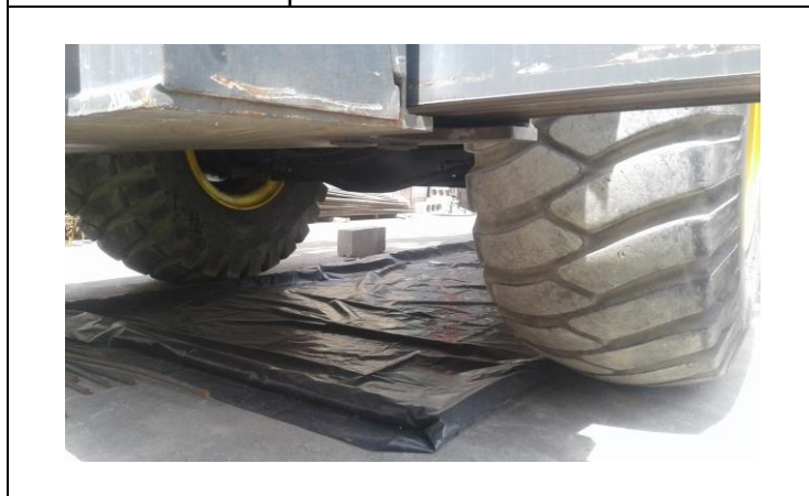
Cubeto en grúa
