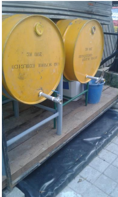
Cubeto en tanques de antisol
