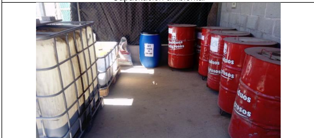
Desechos peligrosos y kit de derrames
