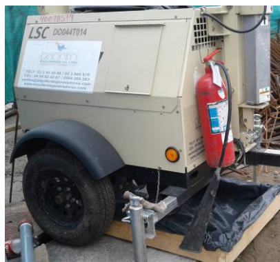
Cubeto en torre de iluminación
