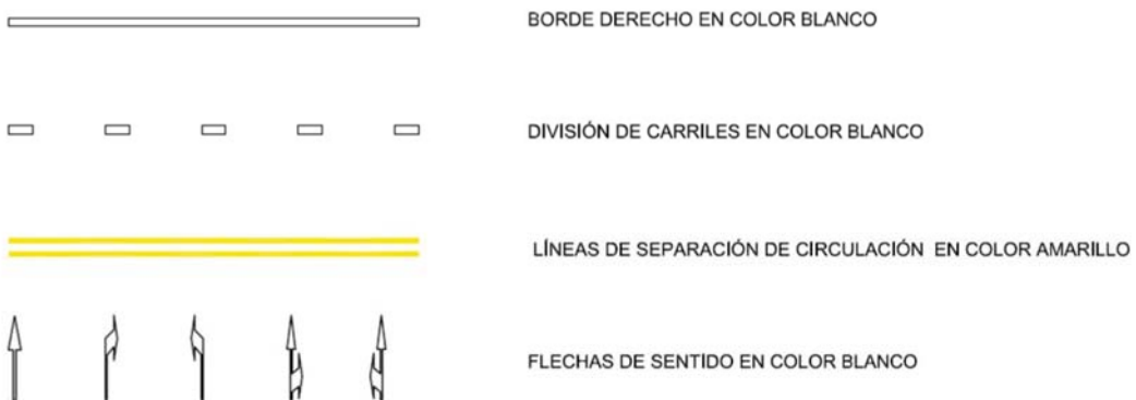
Figura No. 3. Señalización Horizontal.
