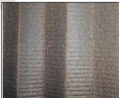
Nota: Cabe mencionar que al realizar el corte de filtros de aceite de motor, no se evidenció presencia de particulado metálico en el papel filtrante.
