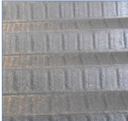
Nota: Cabe mencionar que al realizar el corte de filtros de aceite de motor, no se evidenció presencia de particulado metálico en el papel filtrante.
