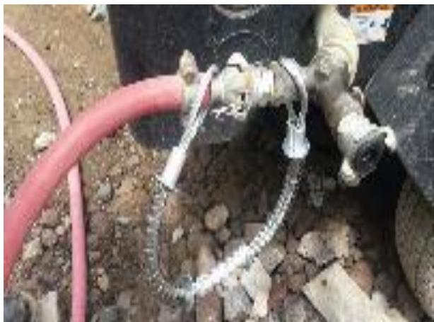
**Foto 55.- Mangueras sujetadores para evitar el efecto látigo.**
