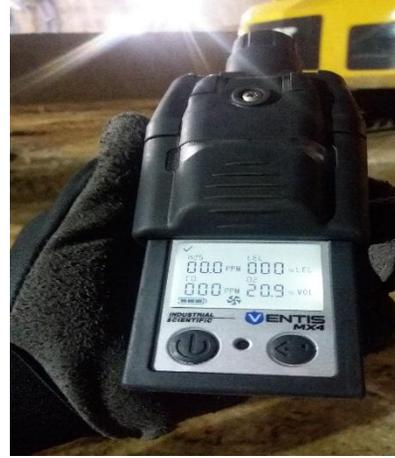
Fotos 36 y 37.- Monitoreo de atmósferas peligrosas en las actividades de excavación en El Labrador.
