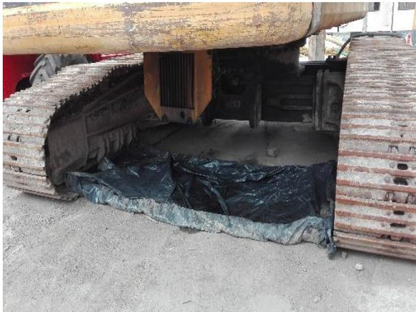
**Foto 13.- Colocación de cubeto antiderrame bajo maquinaria – Morán Valverde.**
