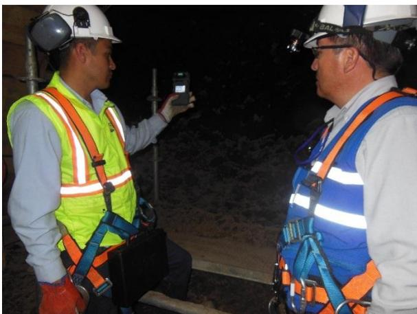
Foto 71.- Mediciones de higiene laboral en obra subterránea (Pozos colectores La Presa).
