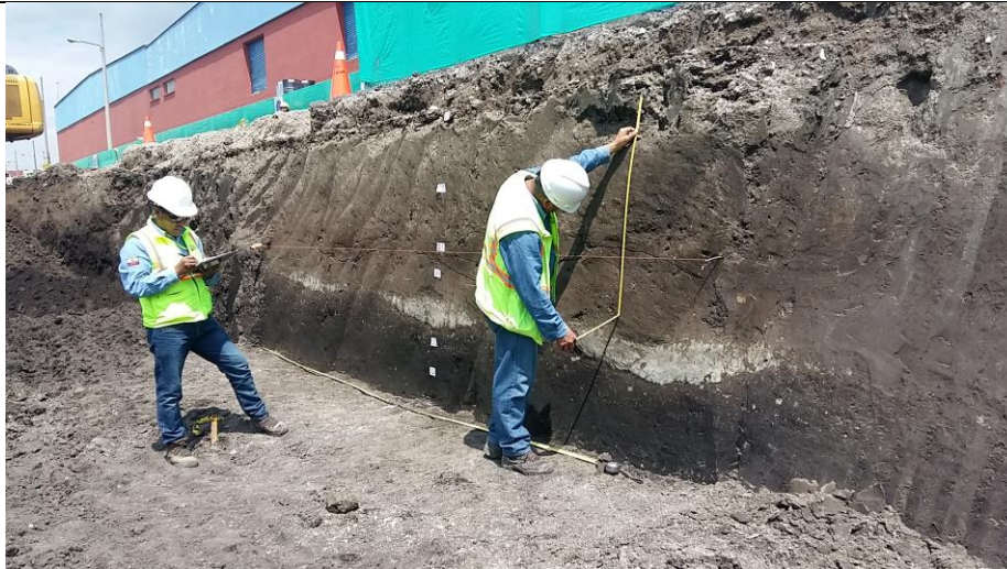
Foto 3 Detalle del registro del perfil este
