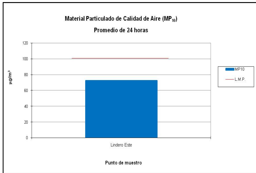
FIGURA 2 DIAGRAMA DE COMPARACIÓN DE LA CONCENTRACIÓN DE CONTAMINANTES CON EL AM 097-A – LINDERO ESTE
