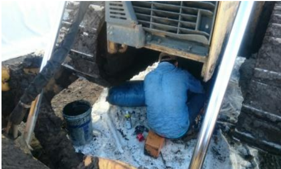
Foto 59.- Cambio de aceite al motor en Patio de Talleres y Cocheras.
