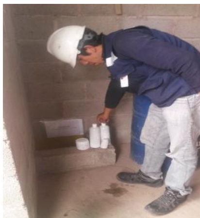
Foto 147 y 148.- Toma de muestra de agua en el piezómetro ubicado en la Estación Jipijapa.
