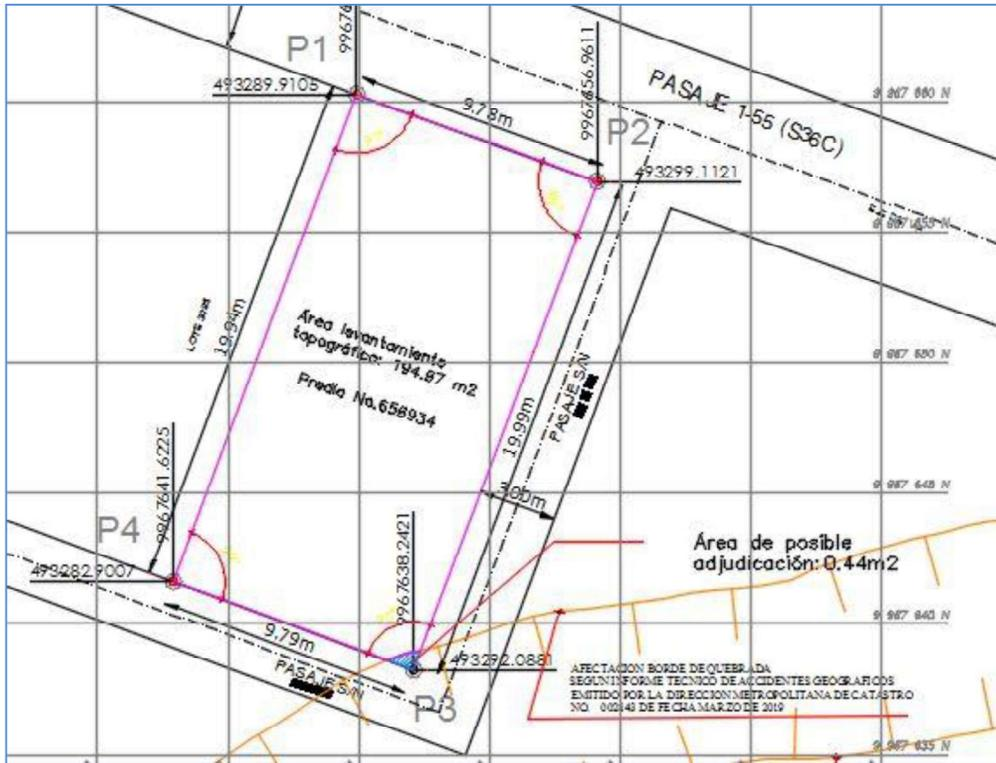
**Gráfico 2:** Levantamiento Topográfico georeferenciado del Predio N° 656934 ingresado por el Sr.Manuel Toscano.
