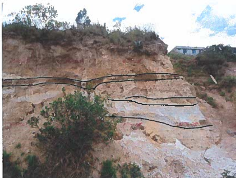
Foto 2. Talud en el que se observa la litología variada que está expuesta a la intemperie. También se observa la perturbación tectónica en las capas de ceniza gris y blanca.
