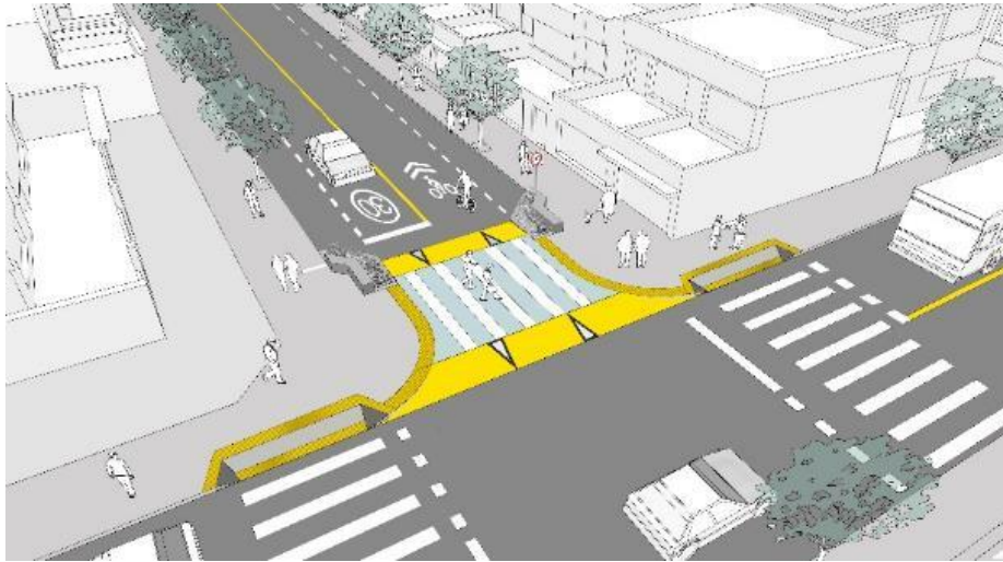
Gráfico 42: Esquema referencial para resalto peatonal en “acceso (1)” o “intersección (3)”
