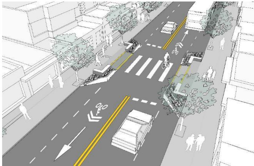
Gráfico 62: Esquema referencial de estrechamiento tipo ii con extensiones de acera en “tramo vial (2)”
