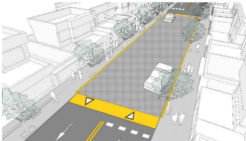
Gráfico 48: Esquema referencial de plataforma única en “tramo vial (2)”
