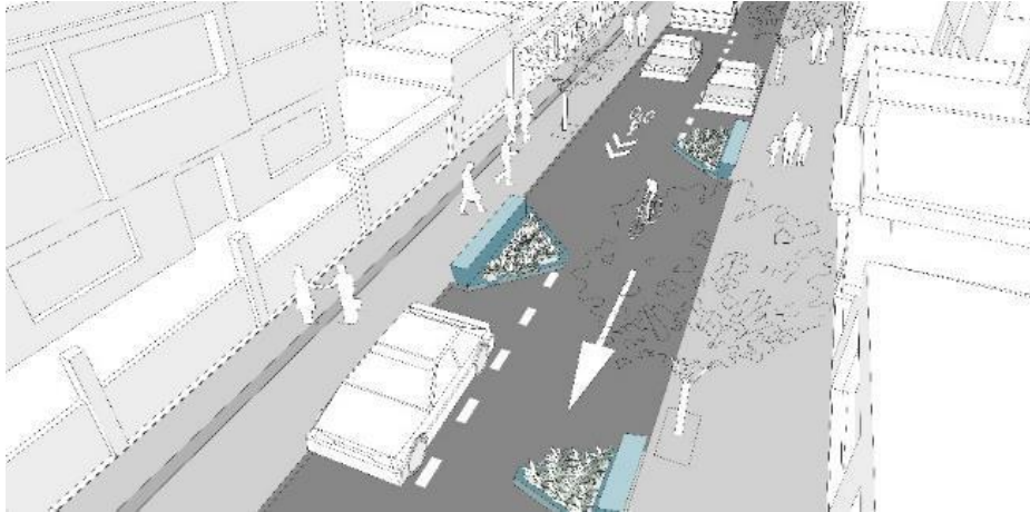
Gráfico 50: Esquema referencial de chicana para vías unidireccionales en “tramo vial (2)”
