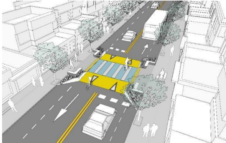
Gráfico 44: Esquema referencial para resalto peatonal en “tramo vial (2)”
