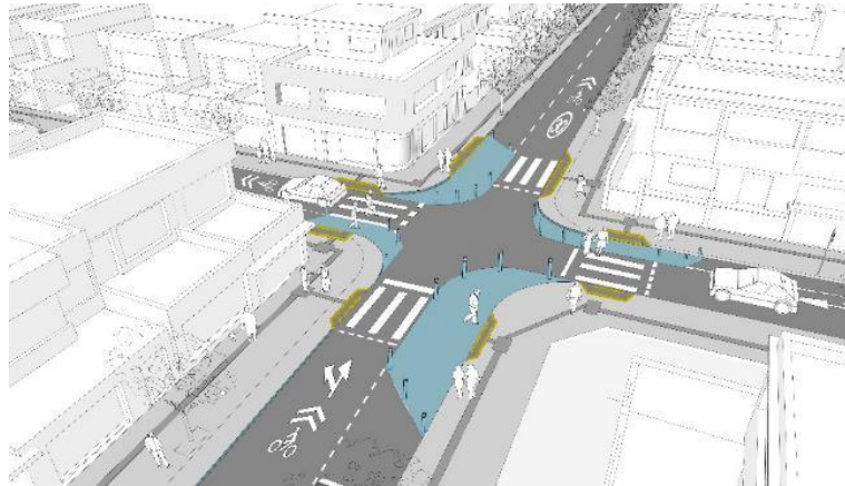
Gráfico 56: Esquema referencial de retranqueo en “intersección (3)”
