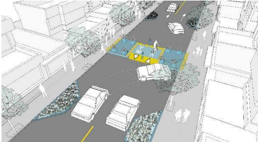
Gráfico 75: Esquema referencial de fondo de saco con filtro modal en “tramo vial (2)”
