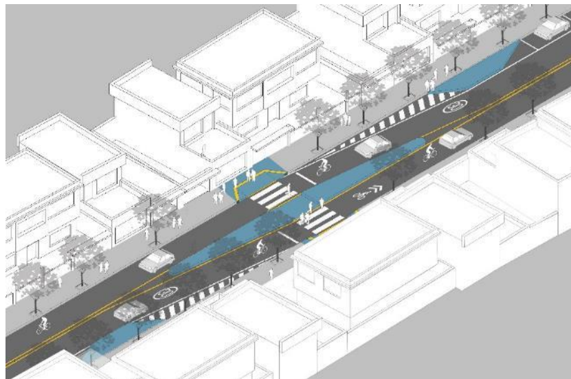
Gráfico 54: Esquema referencial de retranqueo para vía bidireccional en “tramo vial (2)”
