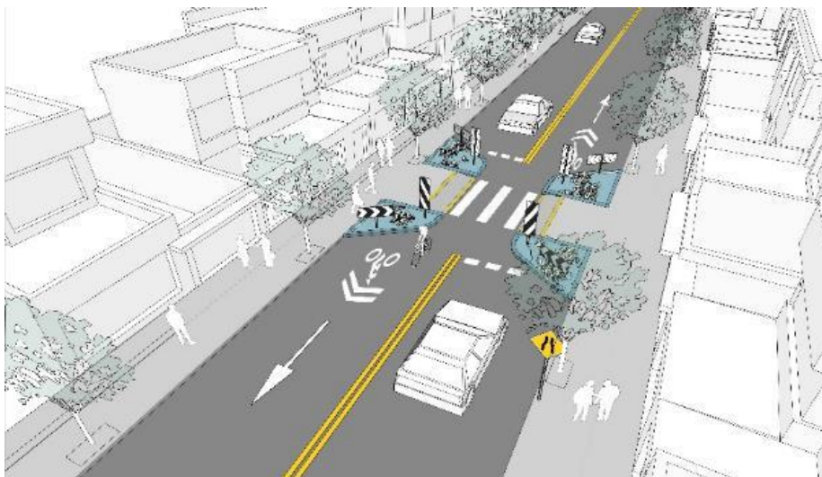
Gráfico 59: Esquema referencial de estrechamiento tipo i con extensiones de acera en "tramo vial (2)"
