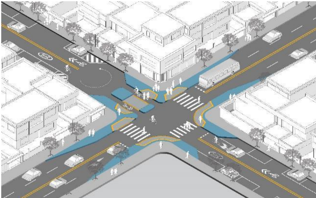
Gráfico 78: Esquema referencial de fondo de saco en “intersección (3)”
