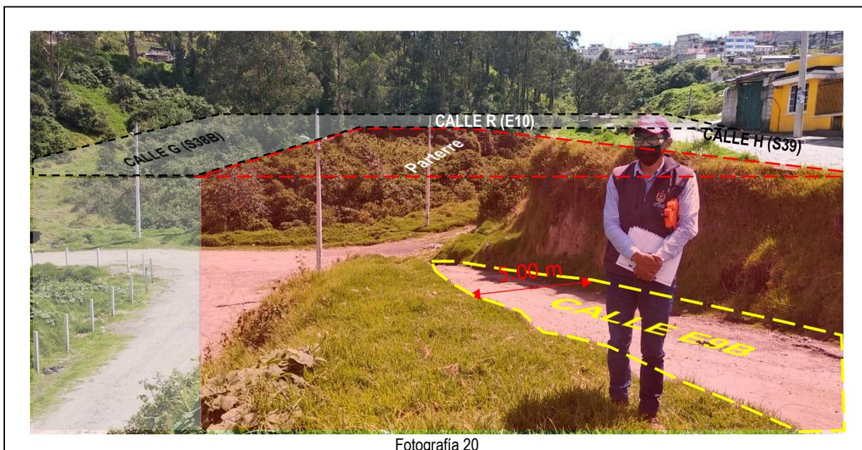
Como se indicó anteriormente, la conexión de la calle "E10" desde la calle "S39" hacia la calle "S38B" no puede ser implantada debido a la diferencia de niveles, motivo por el cual, la calle "E10" se recorta a través de un bordillo curvo. (Ver fotografías 21 y 22).
