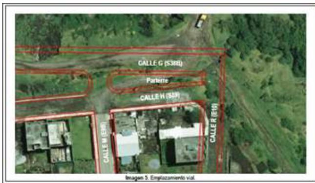
*De la inspección realizada se pudo observar que, debido a la diferencia de niveles, el parterre no puede ser implantado en sitio, así como la conexión de las calles “M” (E9B) y “R” (E10) desde la calle “H” (S39) hasta la calle G (S38B).*
