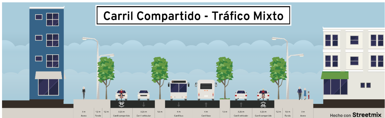
Figura 5-6. Ancho mínimo del carril unidireccional compartido con tráfico mixto
