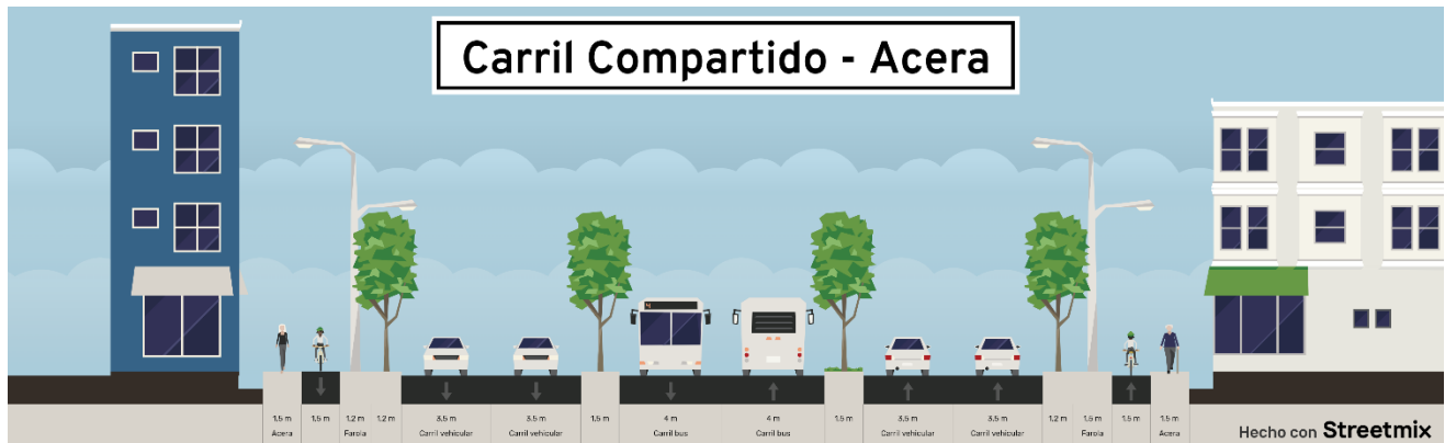
Figura 5-5. Ancho mínimo del carril unidireccional compartido en acera
