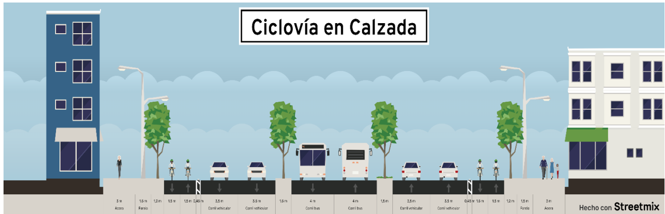
Figura 5-4. Ancho mínimo de la ciclovía bidireccional en calzada
