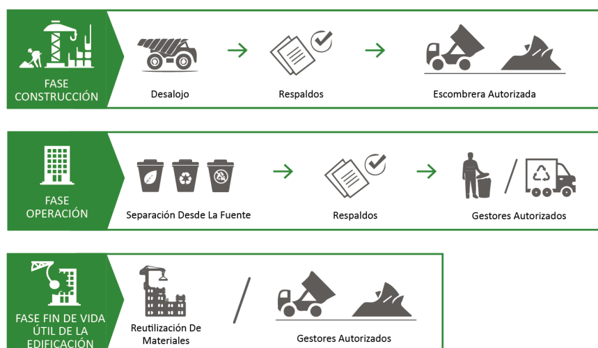
Gráfico 40. Diagrama de gestión integral de residuos durante todas las fases de la edificación
