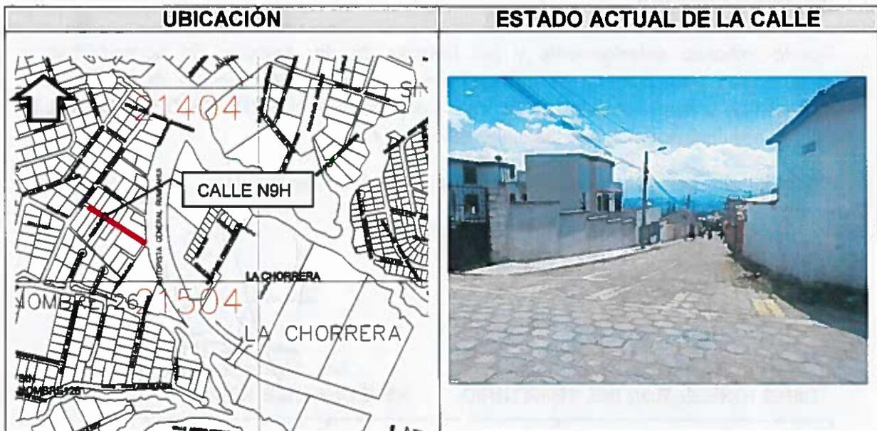
Es una vía existente que se propone regularizar con 9.00m de ancho total, inicia en la intersección con la calle Manuel Samaniego (abscisa 0+000) hacia el Oriente y termina en curva de retorno en el extremo Oriental (abscisa 0+136.17), con las siguientes características técnicas:
