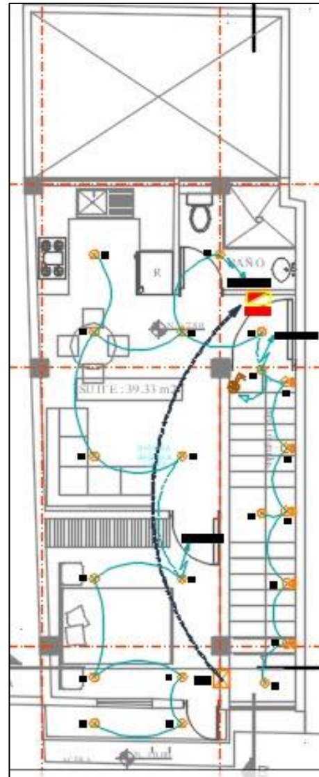
FIGURA 3. Sistema de Iluminación
