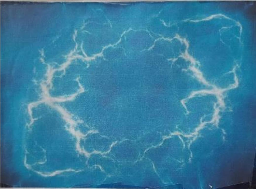
Los experimentos en el laboratorio muestran la formación de centros de gravedad con filamentos en el plasma.
