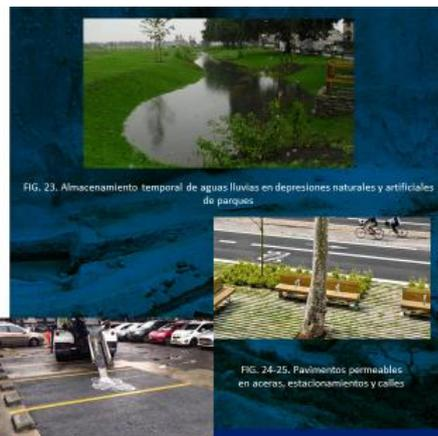
FIG. 23. Almacenamiento temporal de aguas lluvias en depresiones naturales y artificiales de parques
