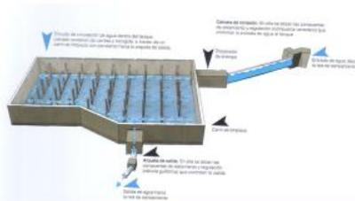
FIG. 26. Esquema de funcionamiento de tanque tormenta
