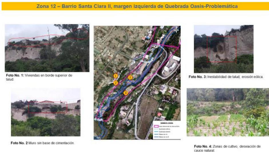
En la zona doce está el Barrio Santa Clara II, el margen izquierdo de la quebrada es el que tiene el problema, en la zona Oasis, viviendas en el borde superior del talud, muros sin base de cimentación. En la fotografía dos, podemos ver ya en el borde de la quebrada,
