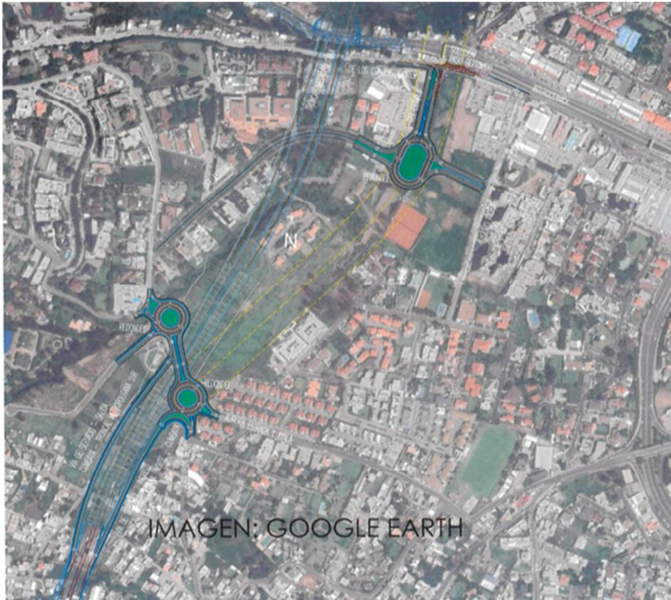
El ancho de las vías propuestas corresponde a un ancho de 3.50m, en concordancia con los anchos de las vías existentes en este sector.
