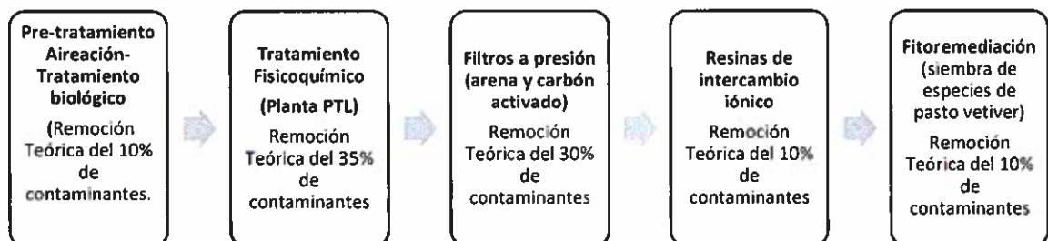
Figura 4. Tren de tratamiento para lixiviados en el Relleno Sanitario de El Inga
