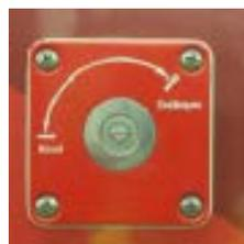
*Figura 8 Dispositivo de desbloqueo exterior de emergencia*
