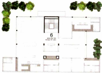
Jardineras en terrazas para aislamiento térmico
