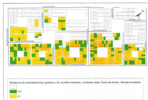
Figura 10: Evidencias de asentamientos en Viviendas / Ciudadela Solanda – Quito
