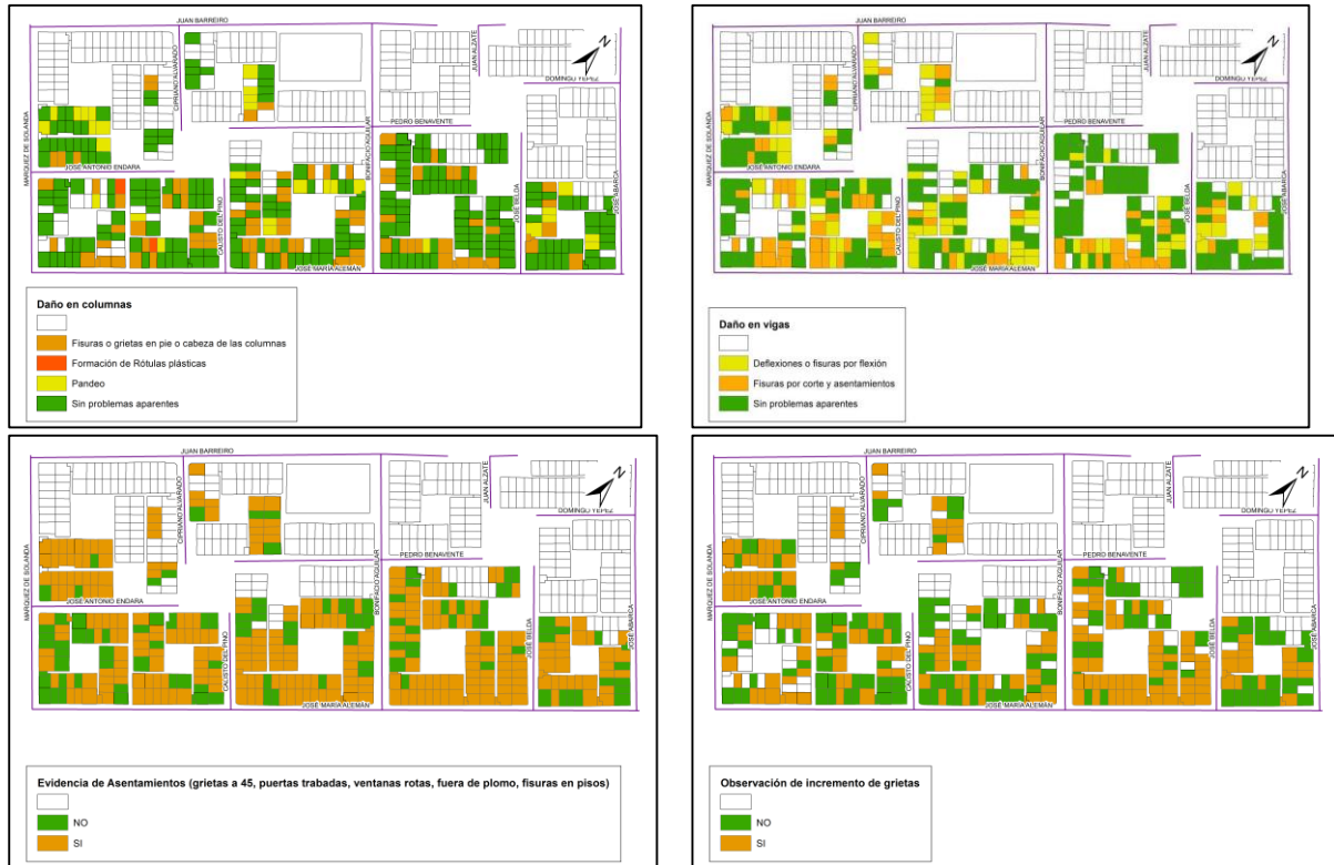
Figura 6: Daño en Columnas. Daño en Vigas. Evidencias de asentamientos en Viviendas. Incremento de grietas en Viviendas.
