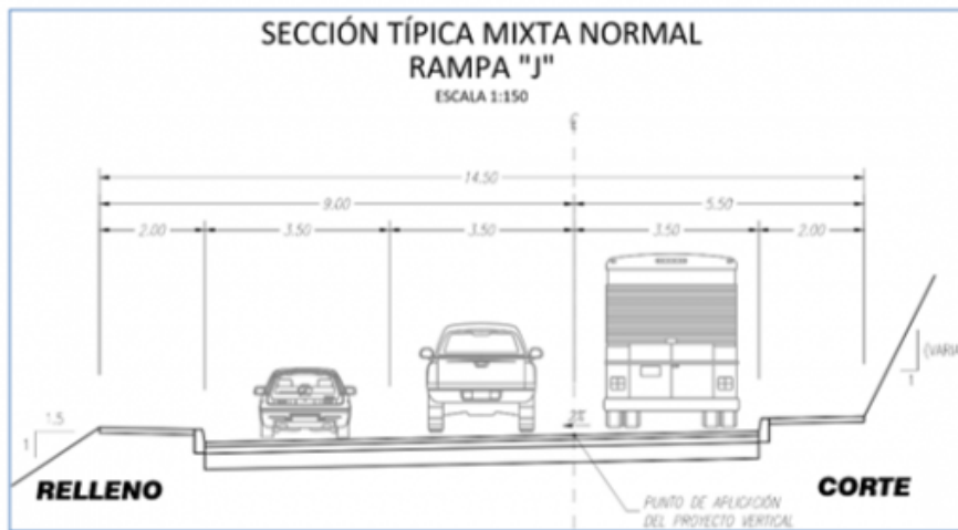
SECCIÓN TÍPICA RAMPA J
