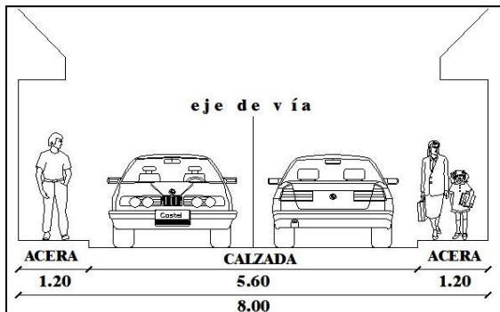
Gráfico 3: Sección transversal de prolongación de “callejón B”
