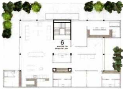
Jardineras en terrazas para aislamiento térmico
