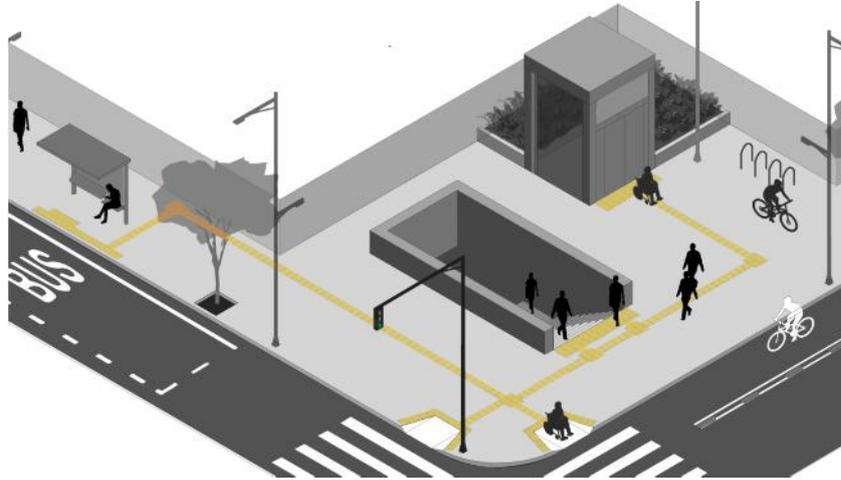
**Gráfico N° 55:** Configuración de señalización horizontal.
