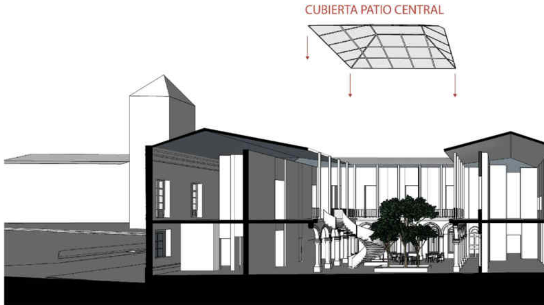
Imagen de cubierta para el patio central
